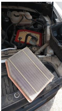
CAMBIO DE FILTRO DE AIRE
