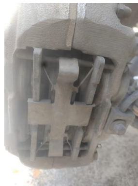
BALATAS DELANTERAS CON MEDIA VIDA
